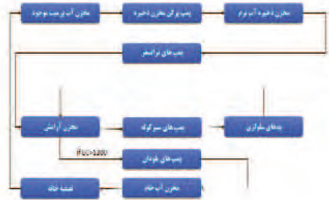
شکل ۵ شماتیک نحوه تولید و توزیع آب در سامانه مدیا نیروگاه سرو (چادرملو)
